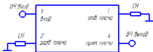
Измерение переходного ослабления НУ
