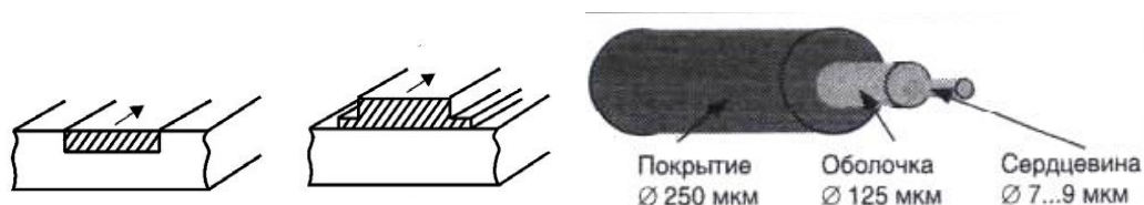
Рис. 1 Оптические волноводы: полосковый внедренный, полосковый гребенчатый, цилиндрический (оптоволокно)
